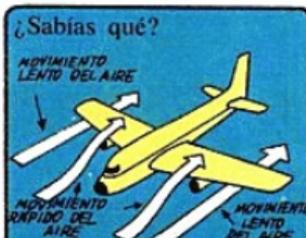
Las alas de los aviones están curvadas en la parte superior. Cuando vuela, el aire de la parte superior se mueve más rápido que el aire de la parte inferior y tiene menos presión. El aire lento de la parte inferior tiene más impulso y lo eleva.
