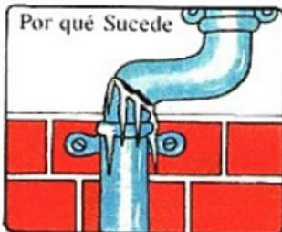
Cuando el agua fría se hiela se agranda y empuja hacia afuera. Su presión es tan fuerte que rompe las tuberías del agua del interior de las casas cuando hace mucho frío.
