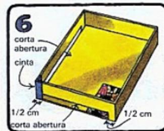
Corta una abertura estrecha a la izquierda del fondo de la caja y otra por la parte de delante, pero no recortes las esquinas. Pega cinta adhesiva en las esquinas, como ves en el dibujo.
