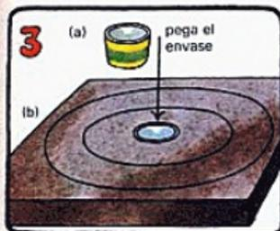
Recorta la parte superior del envase, para que tenga la misma profundidad de la caja (a). Coloca el envase en el centro y dibuja el contorno. Recorta el círculo y pega el envase dentro (b).
