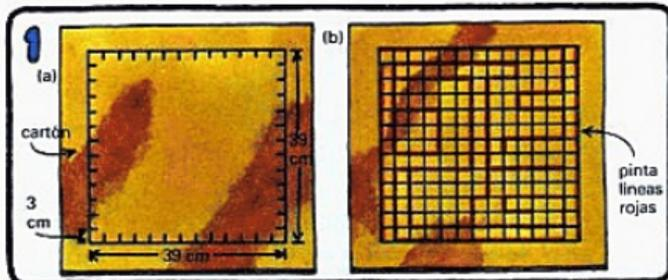
Dibuja sobre el cartón grueso, un cuadrado de 39 cm. de largo y 39 cm. de ancho. Haz marcas cada 3 cm. a los cuatro lados, exactamente como en el dibujo (a).
